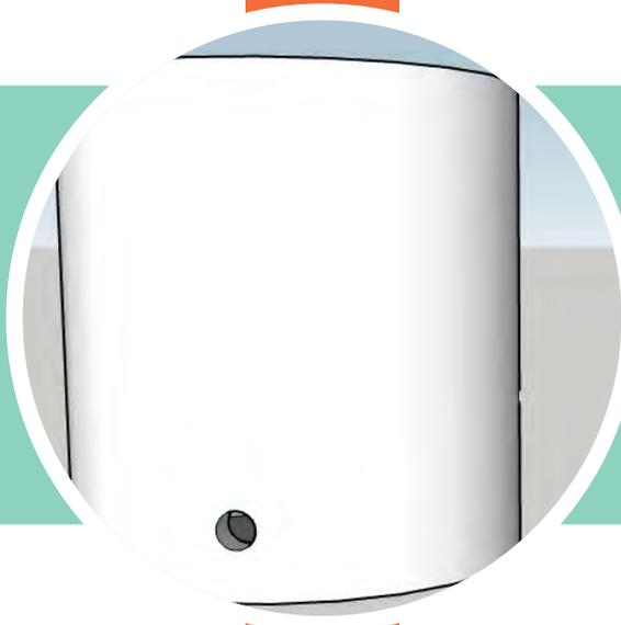
Se abre un hueco de 1 pulgada para la entrada del agua, aquí se busca una unión o flanche que conduzca el agua por tubería.
